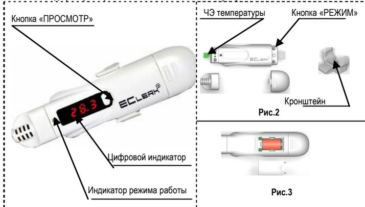
В зависимости от наличия или отсутствия цифрового индикатора и внутренней памяти прибор имеет следующие модификации:
