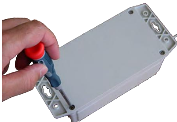
Рисунок 10: Снятие задней крышки
