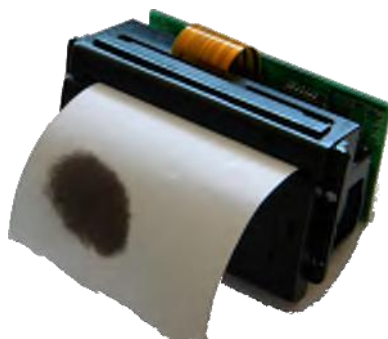
Рисунок 15: Нагретая термочувствительная сторона
